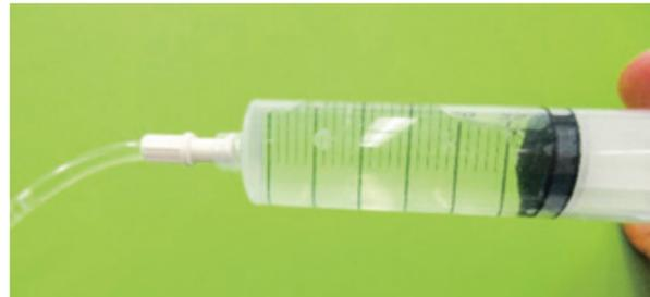
ガスケットが破損し空気が混入!見えるかな?
